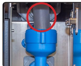
5. Entfernen Sie den Pulverauslaufwinkel über den Instantbehälterauslauf.
