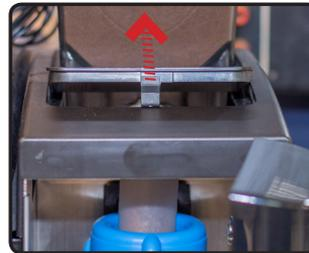
4. Ziehen Sie den Pulverauslaufwinkel aus dem Instantbehälterauslauf.
