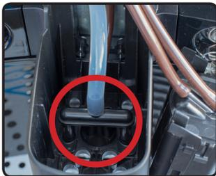
14. Reinigen Sie die Durchgangslöcher des Doppel-Milchauslaufs gründlich mit der Tüllenbürste.
