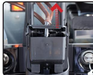
9. Trennen Sie den Kaffeeauslaufschlauch und den Bypass-Schlauch vom höhenverstellbaren Getränkeauslauf.
