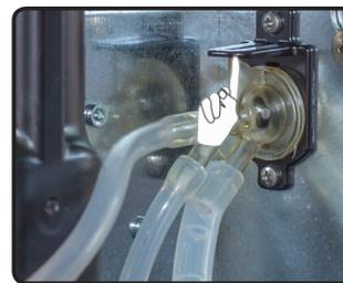
4. Ziehen Sie den Milchaufschäumer gerade aus der Maschine heraus.
