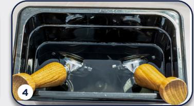
4 Legen Sie alle Siebträger in den Behälter ein (**mit den Griffen außerhalb der Flüssigkeit**). Einwirkzeit: ca. 5 Minuten.
