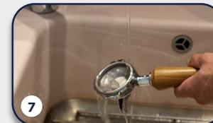
7 Reinigen Sie den Siebträgerkopf unter fließendem, klarem Wasser (7). Setzen Sie die Blindscheibe wieder ein, spannen Sie den Siebträger wieder ein und drücken Sie auf das Symbol „Brühgruppe erneut reinigen“ (8). Warten Sie, bis die Reinigung abgeschlossen ist.
