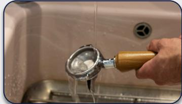
Reinigen Sie den Siebträgerkopf unter fließendem, klarem Wasser.
