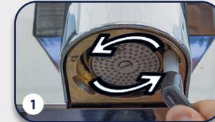
1 Reinigen Sie die Dichtungen der Duschensiebe mit dem Reinigungspinsel.
