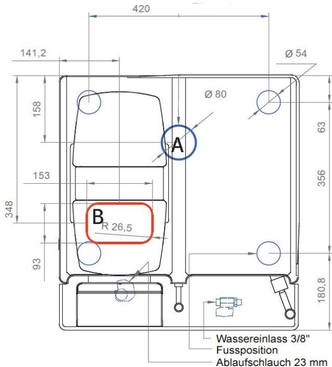
A: Ausschnitt in der Stellfläche für Netzkabel, Wasserschlauch, serielle Schnittstelle, Ethernet
