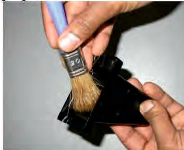
3► Reinigen Sie die Mehrlutsche einmal pro Woche mit einer Bürste und einem Reiniger, der für den Kontakt mit Lebensmitteln geeignet ist.
