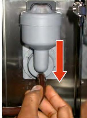
3 ► Drehen Sie den Flansch gegen den Uhrzeigersinn, und entfernen Sie den Mixer.
