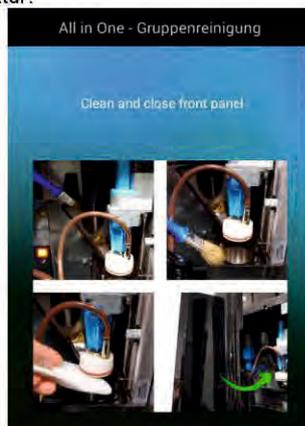
14► Öffnen Sie die Fronttür. Legen Sie eine Reinigungstablette in den Brühraum ein. Schließen Sie die Fronttür.
