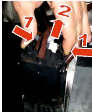
**3▶** Bauen Sie den Cappuccinatore aus dem Kaffeeauslauf aus. Entfernen Sie Silikonschlauch No. 3 und No. 4.
