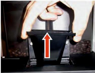
2► Reinigen Sie die Mehrlutsche für koffeinfreien Kaffee einmal pro Woche mit einer Bürste und einem Reiniger, der für den Kontakt mit Lebensmitteln geeignet ist.
