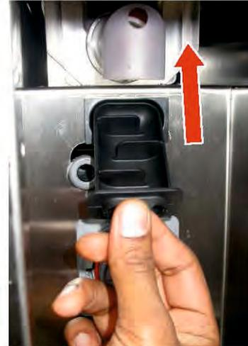
7 ► Befestigen Sie den Mixer. Stecken Sie den Ausgabeschlauch auf.
