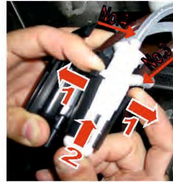
**4▶** Bauen Sie den Cappuccinatore auseinander. Reinigen Sie die Einzelteile gründlich. Entfernen Sie Milchreste aus den Löchern. Prüfen Sie die Dichtungen.
