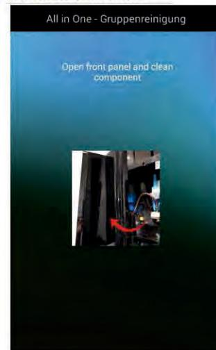
13► Entfernen Sie Kaffeereste aus der Brühgruppe. Reinigen Sie den Kolben mit einem Tuch, und schließen Sie die Fronttür.
