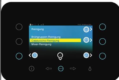
2. 2 Verschlusskappen Milch- und Sahnereiniger in 400 ml kaltem Wasser lösen. Milchschaum in die Reinigerlösung tauchen. Taste
