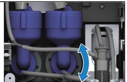
3. Mixer nach vorn abziehen. Einzelteile in eine Lösung aus Wasser und COFFEMA Milch- und Sahnereiniger legen und reinigen. Anschließend gründlich mit fließendem warmen Wasser spülen. Wenn alle Einzelteile komplett trocken sind, in umgekehrter Reihenfolge wieder einbauen.
