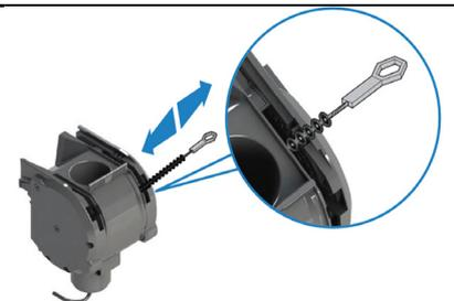
8. Wenn alle Einzelteile komplett trocken sind, Brühgruppe in umgekehrter Reihenfolge wieder einbauen.
