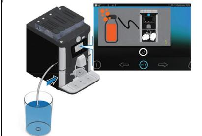
3. Um alle Reinigerreste zu entfernen, Milchschaum in einen Behälter mit 1 l klarem Wasser legen. Taste
