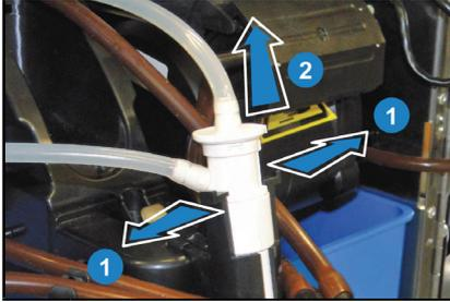
2. Anschlusschläuche des Milchaufschäumers lösen.
