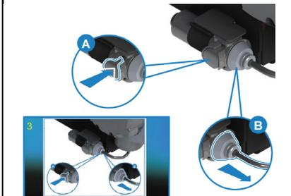
5. Ablaufschlauch A abziehen. Roten Hebel B nach links drücken.
