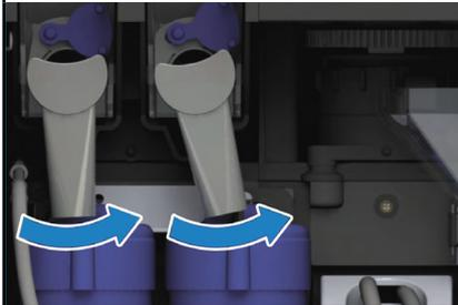
2. Bajonettverschluss drehen, bis die Zungen mit den entsprechenden Schlitzen übereinstimmen.
