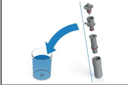
5. Auslaufdüse des Milchaufschäumers mit der Flaschenbürste reinigen, um Rückstände zu beseitigen. Einzelteile mit warmem Wasser spülen. Wenn alle Einzelteile komplett trocken sind, Milchaufschäumer in umgekehrter Reihenfolge wieder einbauen.
