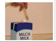
CAPPU.REINIGUNG REINIGER FUER CAPPUCCINATORE TASTE 7 DRUECKEN 2 Verschlusskappen Milch- und Sahnereiniger in 400 ml kaltem Wasser lösen.
