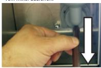
Flansch gegen den Uhrzeigersinn drehen und Mixer ausbauen.
