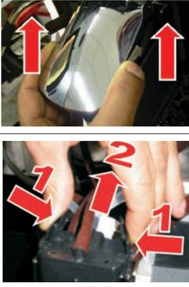
**2** Cappuccinatore aus dem Kaffeeauslauf ausbauen. Silikonschlauch No. 3 und No. 4 entfernen.
