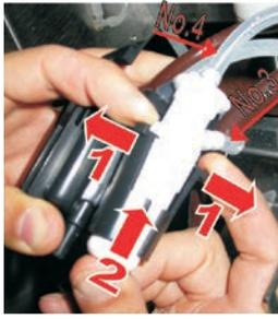
**3** Cappuccinatore auseinanderbauen. Einzelteile gründlich reinigen. Milchreste aus den Löchern entfernen. Dichtungen prüfen.
